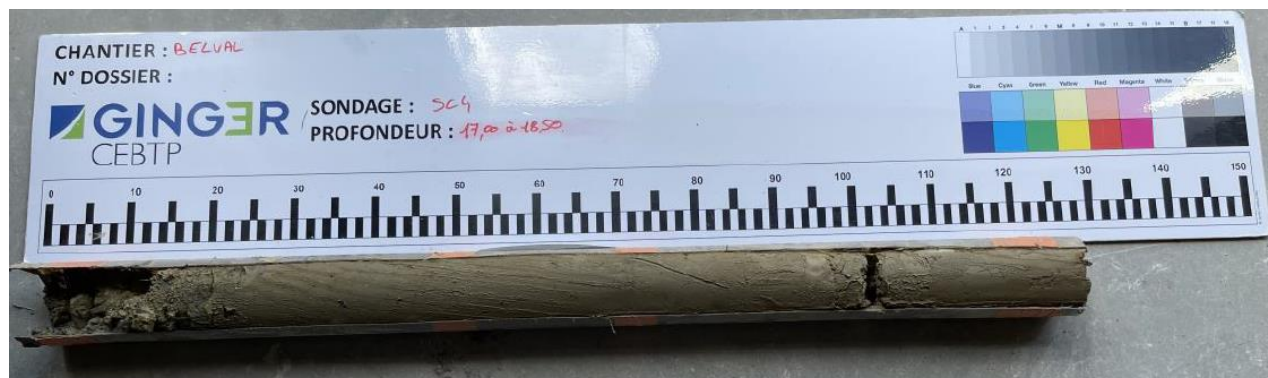
Figure 20. Photo du sondage carotté SC4 entre les profondeurs 17,00 et 18,50 m/TN [15]
